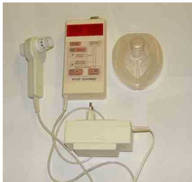
Рисунок 16. Капнографический аппаратно-программный комплекс КП-01 «ЕЛАМЕД»
